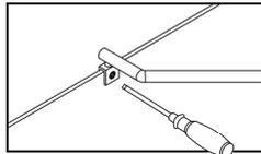
Richten Sie die Halterung am Glas nochmals aus. Drehen Sie die schraube nun so weit fest, bis Sie einen leichten Gegendruck auf der Schraube spüren.
