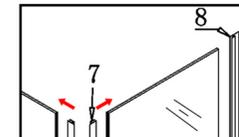
Drücken Sie die Magneteiste an der Vorderkante bei beiden Türen auf. Drücken Sie die h-Dichtung auf die Hinterkante der Tür auf. Achten Sie darauf, das die breite Seite innen montiert ist.
