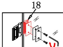
Setzen Sie von außen das Scharnier an schrauben es von innen fest. Beachten Sie dabei, dass zwischen Glas und Scharnier eine Gummi-dichtung sein muss. Wichtig: Bitte ziehen Sie die Schrauben nach ca. einer Woche noch Mal nach.
