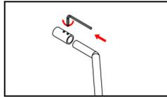
Hängen Sie die die Wandhalterung in die Glasscheibe ein und schieben Sie das Gegenstück in die Öse. Richten Sie die Wandhalterung aus und Schrauben diese an der Öse fest.
