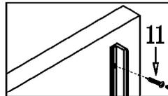
Setzen Sie die Wandschiene an der Wand an und drehen die Schrauben in die Dübel. Richten Sie die Schiene noch-mals mit der Wasserwaage aus und ziehen die Schrauben fest an.
