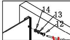
Setzen Sie die Glasscheibe an das Wanprofil an und richten Sie die Scheibe nach den Löchern mit Gewinde aus. Schieben als erstes die Unter-legscheibe aus Metall und an-schließend die aus Kunststoff auf die Schraube und drehen diese im Wandprofil fest.
