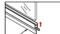
Drücken Sie die Dichtung auf die Unterkante der Scheibe.
