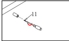
Positionieren Sie die Öse über dem gebohrten Loch und drehen Sie die Schraube in den Dübel.
