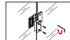
Schrauben Sie nun die Glas-türen von innen am Scharnier fest. Bitte beachten Sie wieder, dass zwischen Glas und Metall-platte eine Gummidichtung an-gebracht werden muss.
