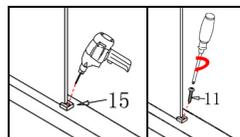
Richten Sie die Scheibe noch-mals mit einer Wasserwaage aus. Markieren Sie nun mit einem Stift die Bohrstelle. Bohren Sie mit einem Bohrer der Stärke 6mm ein Loch in die Duschtasse und schrauben die Bodenbefestigung fest.
