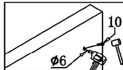
Bohren Sie mit einem Bohrer der Stärke 6mm die ange-zeichneten Löcher und drücken anschließend den Dübel in das Loch.
