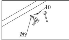
Bohren Sie mit einem 6mm Bohrer die angezeichneten Löcher und drücken anschließend den Dübel hinein.
