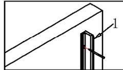
Richten Sie das Wandprofil mit einer Wasserwaage aus und zeichnen Sie die Bohr-löcher mit einem Stift an.
